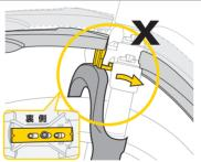
告: ディフェンダーM1をサス フォークへ取り付けるときは、フォークの 作動範囲で接触することが無いことを確 認してください。フォークと接触するよ うなことがあれば、ディフェンダーM1 や自転車を破損させたり、ケガを負った りする恐れがあります。
